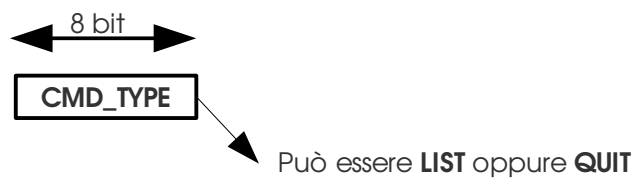
Figura 11: Interfaccia AC: Struttura dei messaggi QUIT e LIST
